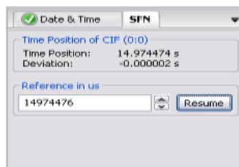
Bild 13 – SFN-Reiter im ETI-XPlorer-Fenster, das die zeitliche Lage des empfangenen HF-Signals anzeigt
